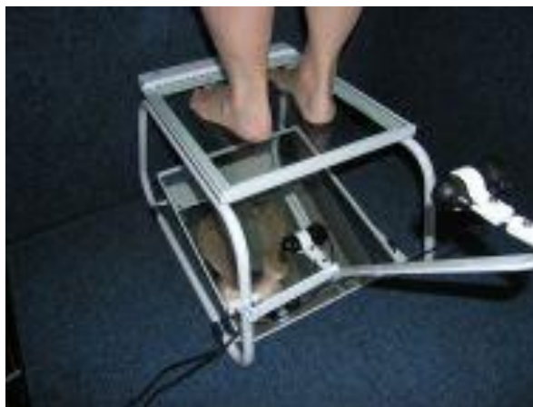
Obr.17: Systém PodoCam pro zobrazení nohy s průhlednou podložkou, zrcadlem a dvěma kamerami (Havrda, 2013, http://www.medsport.cz/podocam.html ).
